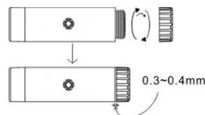
Avant utilisation, s'assurer que le joint d'étanchéité principal (6) ainsi que le joint de fond de bouchon soient correctement en place. Puis visser fermement le bouchon sur le corps de la caméra jusqu'à ce que le joint principal (6) ne soit plus visible que sur 0.3 à 0.4 mm. (force de serrage d'environ 1 kg)
